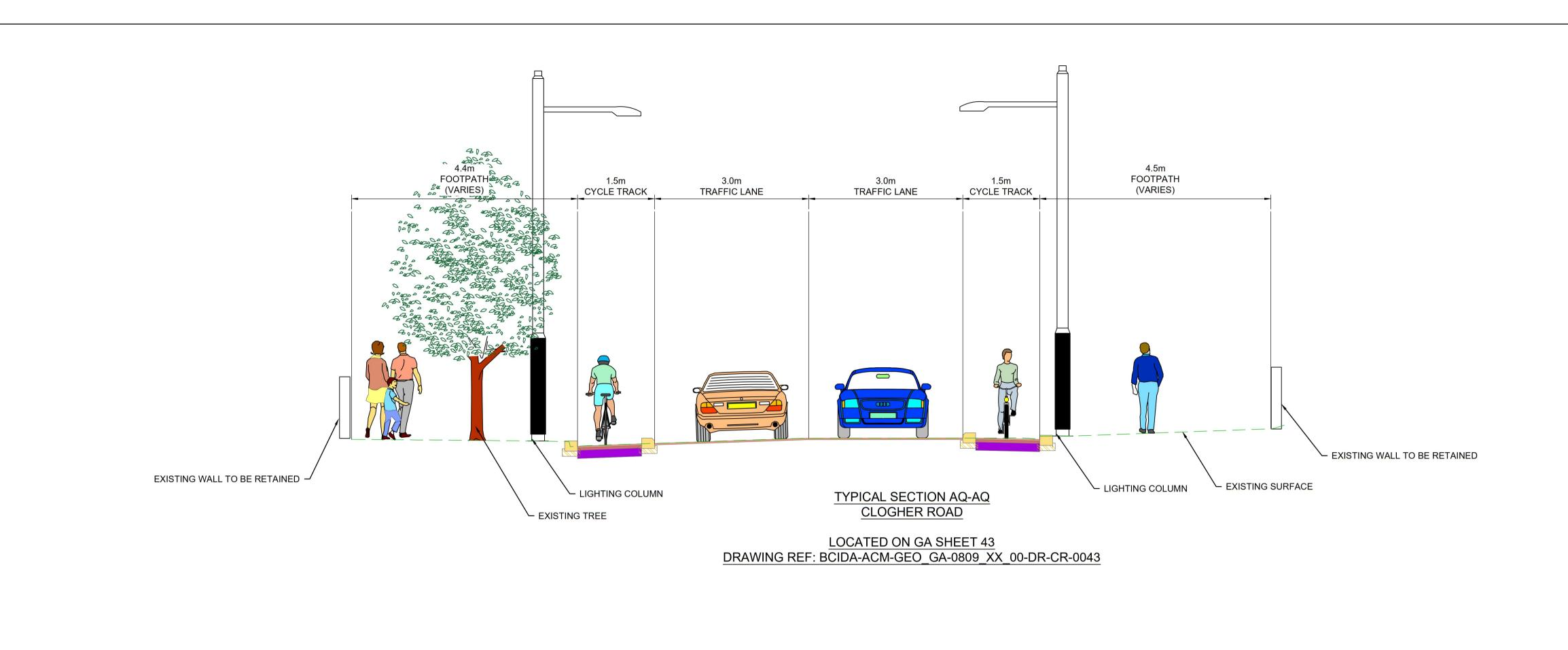
4.5m FOOTPATH FOOTPATH 3.0m TRAFFIC LANE (VARIES) CYCLE TRACK TRAFFIC LANE CYCLE TRACK TYPICAL SECTION AR-AR EXISTING WALL TO BE RETAINED - LIGHTING COLUMN - EXISTING WALL TO BE RETAINED CLOGHER ROAD LIGHTING COLUMN - EXISTING TREE LOCATED ON GA SHEET 44 - EXISTING SURFACE DRAWING REF: BCIDA-ACM-GEO\_GA-0809\_XX\_00-DR-CR-0044
